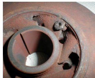
13 | Fremdkörper im Laufrad
