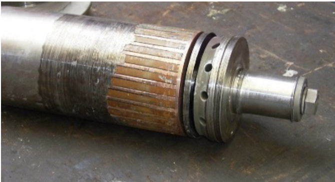
56 | Durch Trockenlauf beschädigtes hinteres Gleitlager
