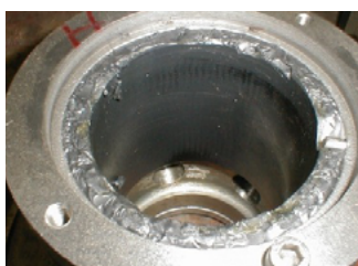
50 | Abplatzen des Lagerwerkstoffes Siliciumcarbid SiC
