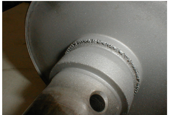
19 | Korrosionsangriff an der Schweißnaht einer Rotorummantelung
